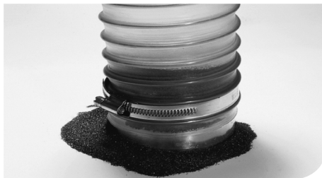
Deutliche Leckage bei Verwendung herkömmlicher Schlauchschellen.
